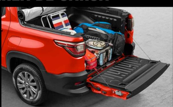
Cuenta con un recubrimiento plástico de uso rudo de tipo BEDLINER con guías para partición y hasta 10 ganchos de sujeción, útiles para fijación y amarre de carga.
