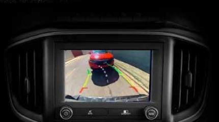
La imagen visible en la pantalla de 7" del centro de info-entretenimiento es asistida con guías activas, las cuales siguen el movimiento del volante de dirección para facilitar la maniobra en reversa.
