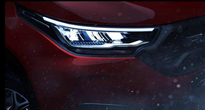
Para conducir de forma segura, esta pickup integra un sistema de iluminación en faros superiores frontales en luz LED, que produce menor intensidad calorífica y mejor calidad de luz exterior, con una mayor intensidad luminosa que mejora la visibilidad del conductor ante condiciones de oscuridad en el exterior.
