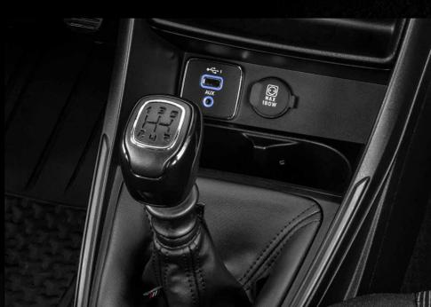
Cuenta con transmisión manual de 5 velocidades y reversa con sistema GEAR SHIFT INDICATOR, el cual permite optimizar el desempeño del motor avisando en el cuadro de instrumentos el momento preciso para realizar los cambios de velocidad, tanto ascendentes como descendentes.
