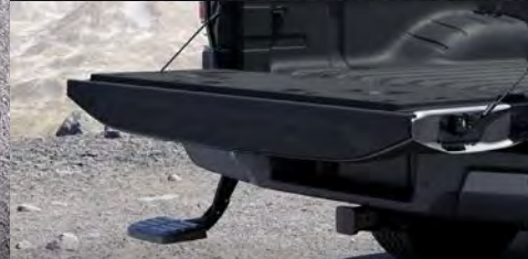
Escalón retráctil para acceso al área de carga
